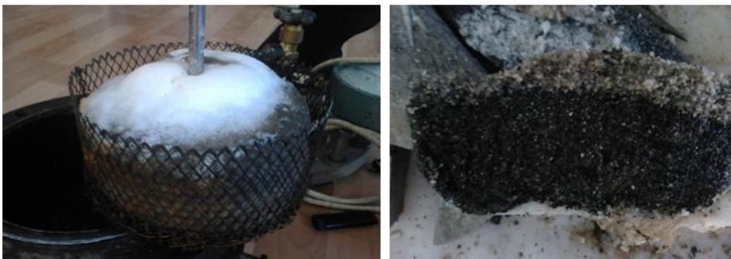
Рис.7. Фотографии гидрата метана, синтезированного в грунте с водонасыщенностью 30 мас.% и начальном давлении 45 атм
