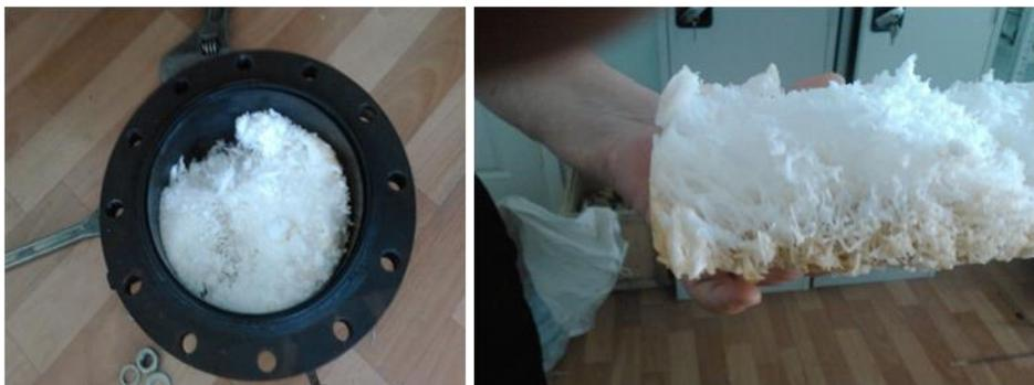
Рис.2. Фотографии гидрата метана, полученного из дистиллированной воды объемом  $1000 \text{ см}^3$  и начальном давлении  $8,5 \text{ МПа}$
