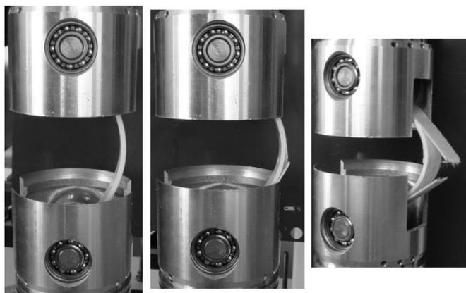
Рис.4. Фотография разрушения образца при продольном изгибе.
