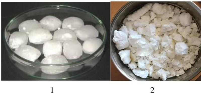
Рис. 2. Синтезированные ГПГ: 1 – таблетки гидратов из Японской установки [1]; 2 – куски гидратов из реактора закрытого типа
