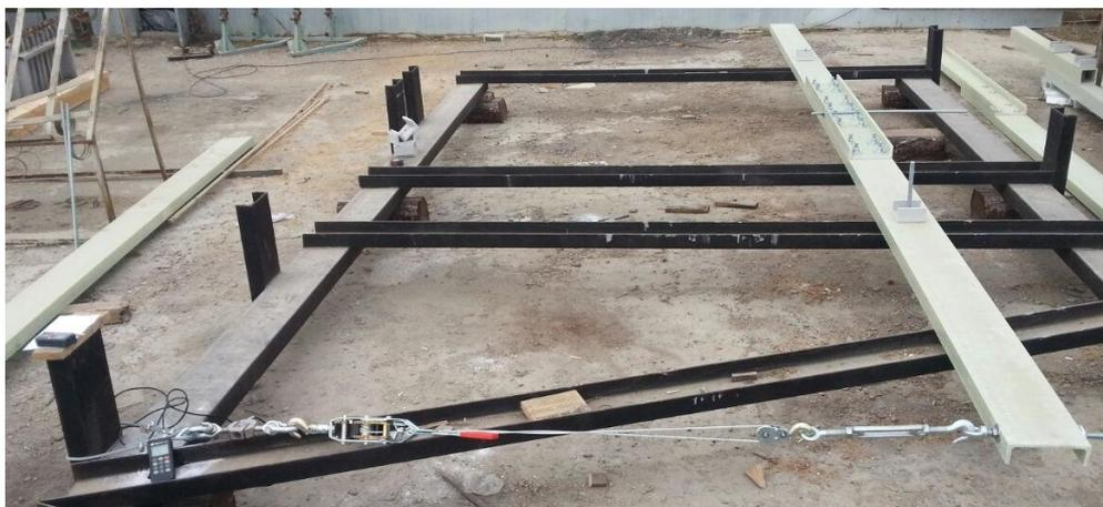
Рис.2. Стендовые испытания траверсы опоры ЛЭП 110 кВ.
