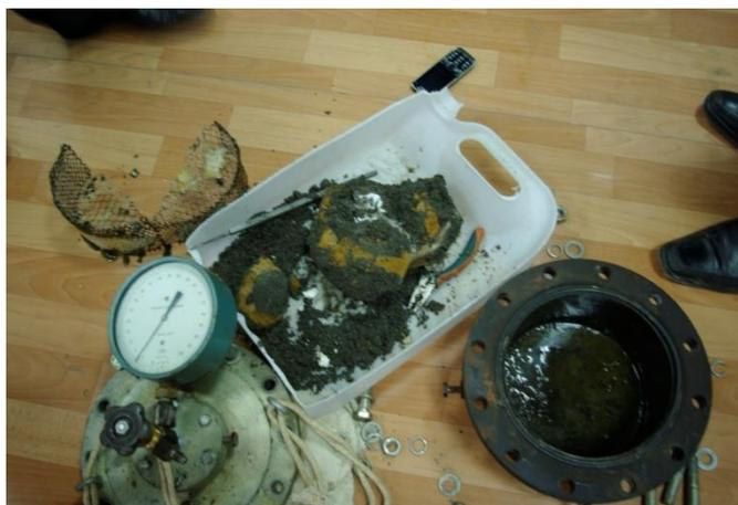
Рис.9. Фотографии гидрата метана, синтезированного в грунте с водонасыщенностью 30 мас.% и начальном давлении 90 атм
