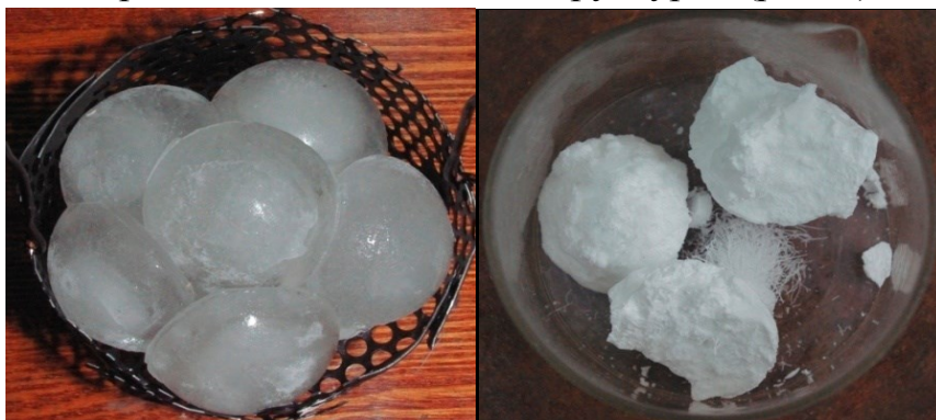
Рис. 4. Синтетические гидраты природного газа, полученные из полусферических заготовок льда размером до 4 см
