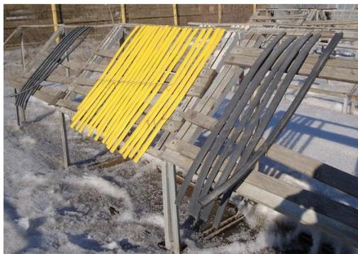
Рис.29. Образцы полиэтиленовых труб, изготовленные по технологии экструзии
