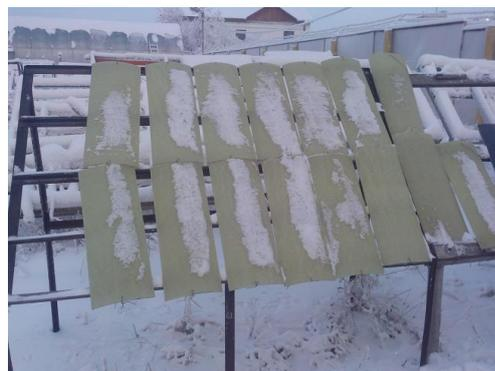
Рис. 28. Образцы из стеклопластика на эпоксидной основе, изготовленные по технологии намотки
