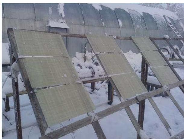
Рис.27. Образцы из стеклопластика на полиэфирной основе, изготовленные по технологии пултрузии
