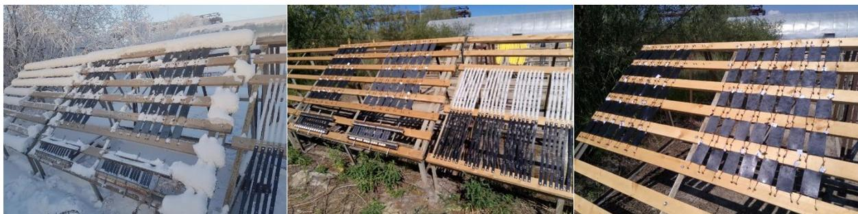
Рис. 1 - Экспозиция резиновых образцов на климатическом полигоне для натурных испытаний
