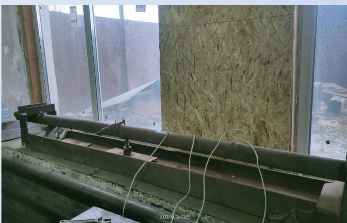
Рис. 1. Экспериментальный стенд для изучения напряженно-деформированного состояния трубы
