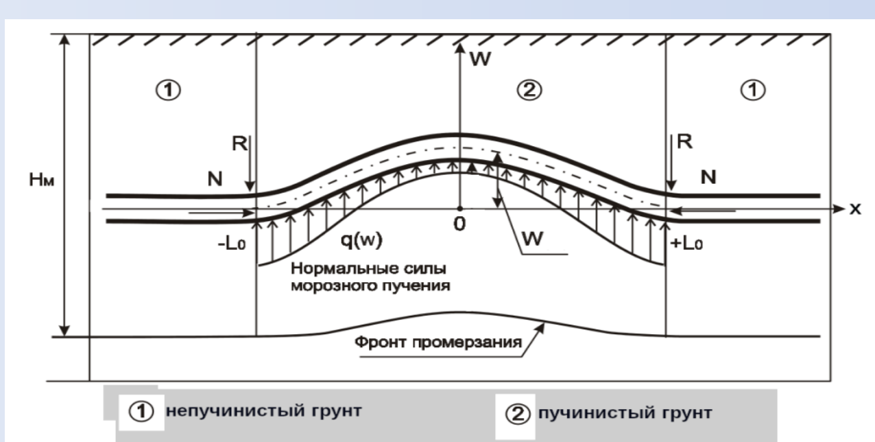
Рисунок 1 – Расчетная схема силового взаимодействия трубопровода с пучинистым грунтом
