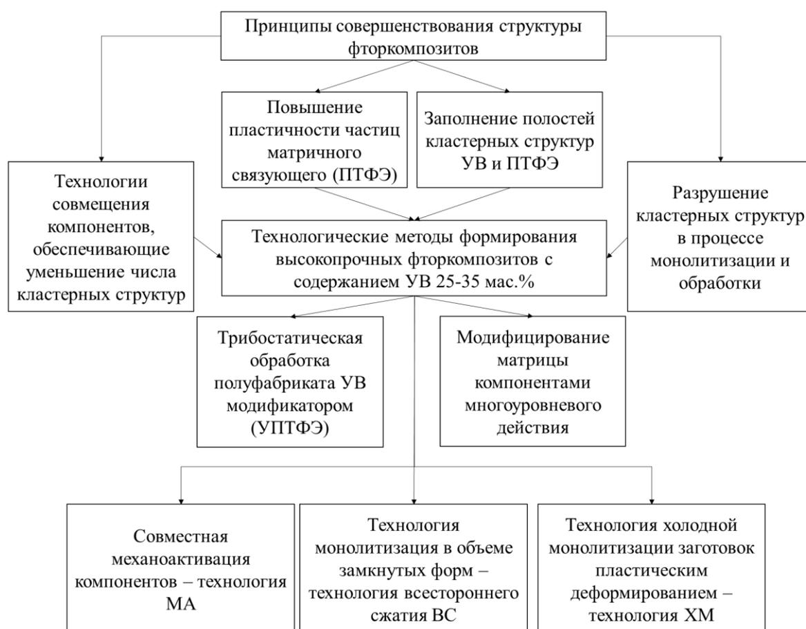
Рисунок 1.1 – Технологические методы получения высокопрочных износостойких фторкомпозитов с повышенным содержанием УВ [68]
