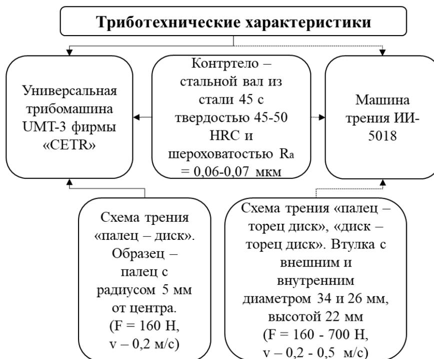
Рисунок 2.4 – Схемы и условия трения ПКМ
