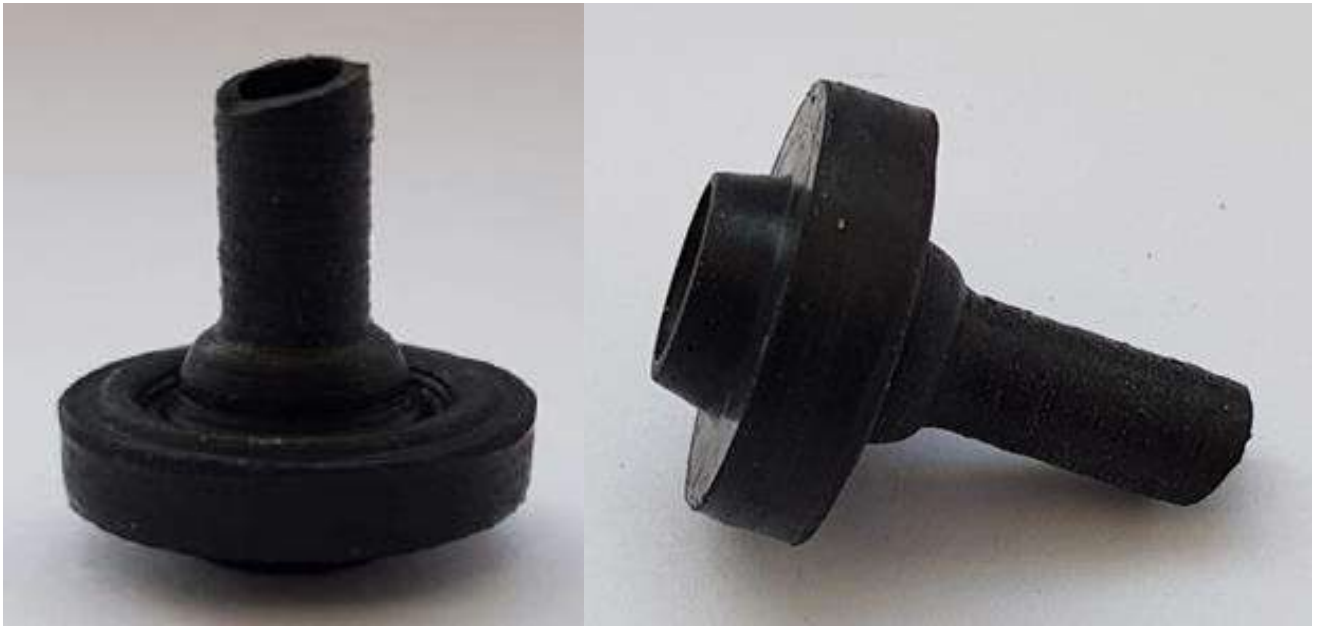
Рисунок 5.1 – Уплотнительная манжета для заправочных пистолетов (15x5 мм)
