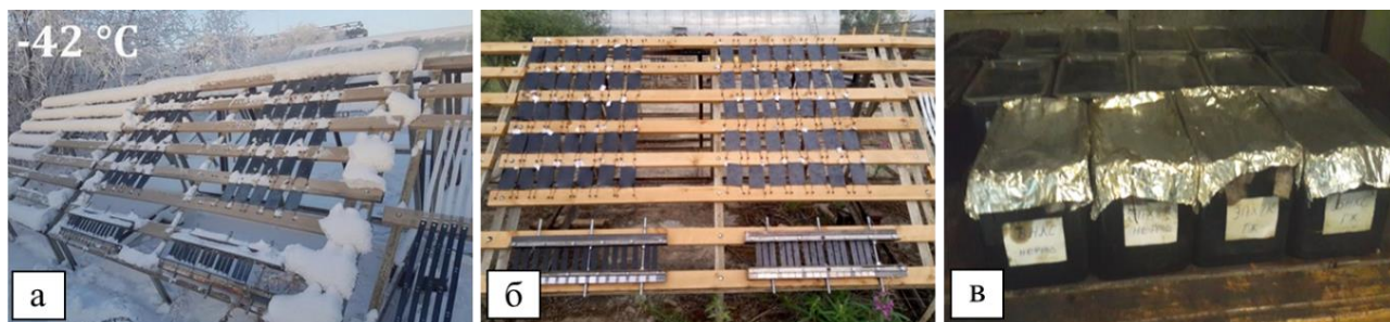
Рисунок 5 – Экспонирование образцов на климатическом полигоне ИПНГ СО РАН (а, б) и в помещении (в)
